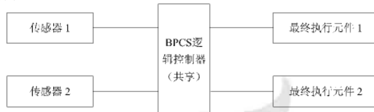
图 D.1 同一场景下共享同一 BPCS 逻辑控制器的多条回路
