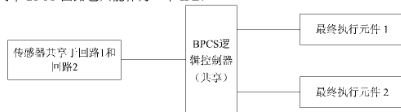
图 D.2 同一场景下共享传感器的 BPCS 回路
