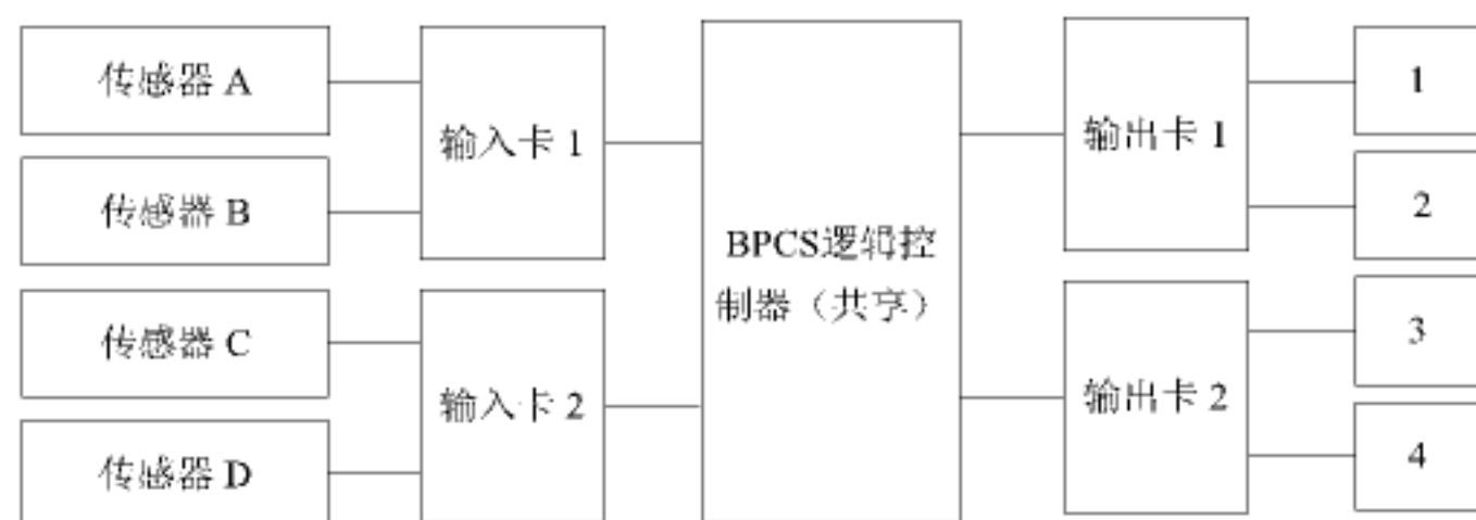
图 D.3 相同场景下共享输入/输出卡的影响
